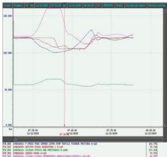
Slika 10 – Rad regulatora snage pri padu pritiska pare
