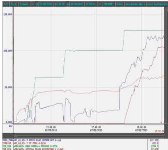
Slika 9 – Izvođenje turbine na nominalnu brzinu, sinhronizacija, opterećivanje
